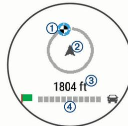
El indicador del destino ① muestra en qué dirección se encuentra tu destino en relación a la dirección en la que estás avanzando ②. Cuando el indicador del destino se muestra en la parte superior del círculo, significa que tu dirección es correcta. La distancia restante hasta tu destino ③ se indica en la parte inferior del círculo. La barra de progreso ④ indica el progreso hasta tu destino.
