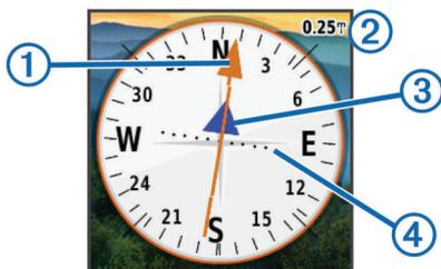
El puntero de trayecto ① indica tu relación respecto a la línea de trayecto que conduce al destino. El indicador de desvío de trayecto (CDI) ② proporciona la indicación de desvío (derecha o izquierda) del trayecto. La escala ③ corresponde a la distancia existente entre los puntos ④ del indicador de desvío de trayecto, que te indica la distancia que te has desviado respecto al trayecto.
